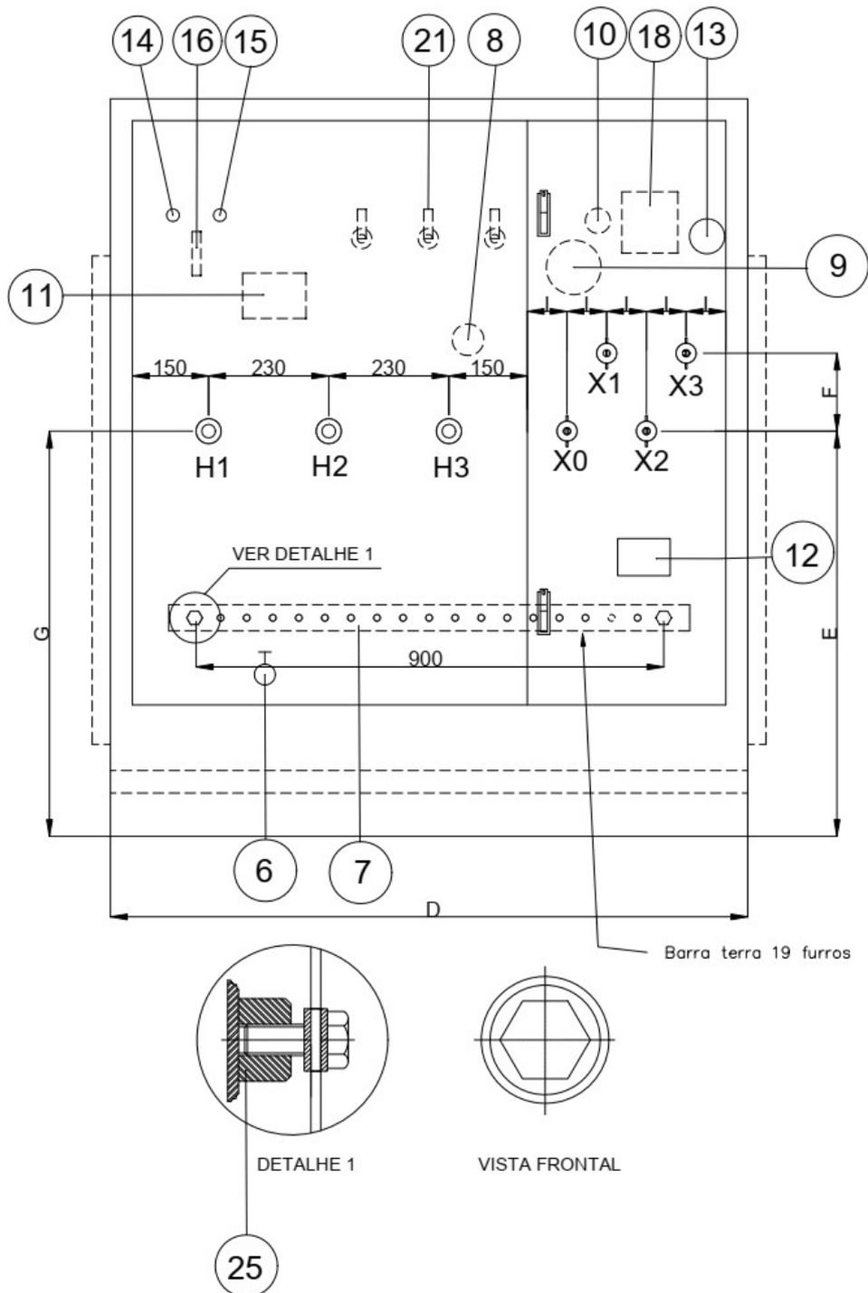
**Figura 1** - Transformador pedestal radial - vista frontal
