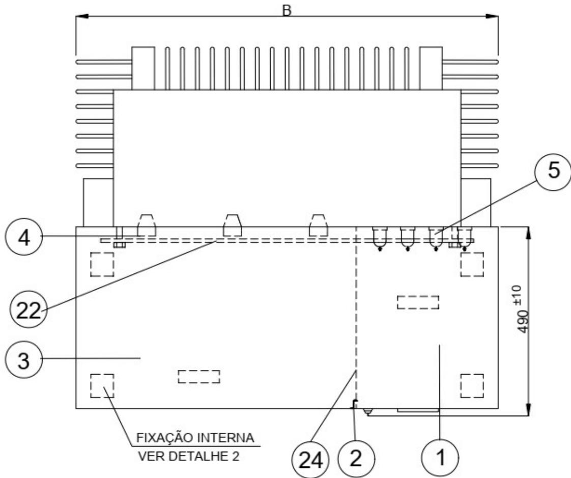
**Figura 3** - Transformador pedestal radial – vista superior
