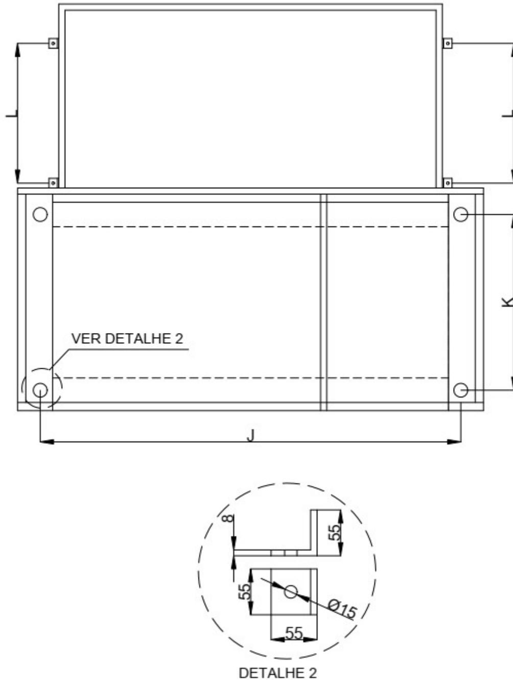
**Figura 4** - Transformador pedestal radial - vista inferior
