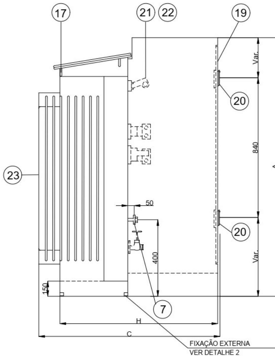
**Figura 2** - Transformador pedestal radial – vista lateral
